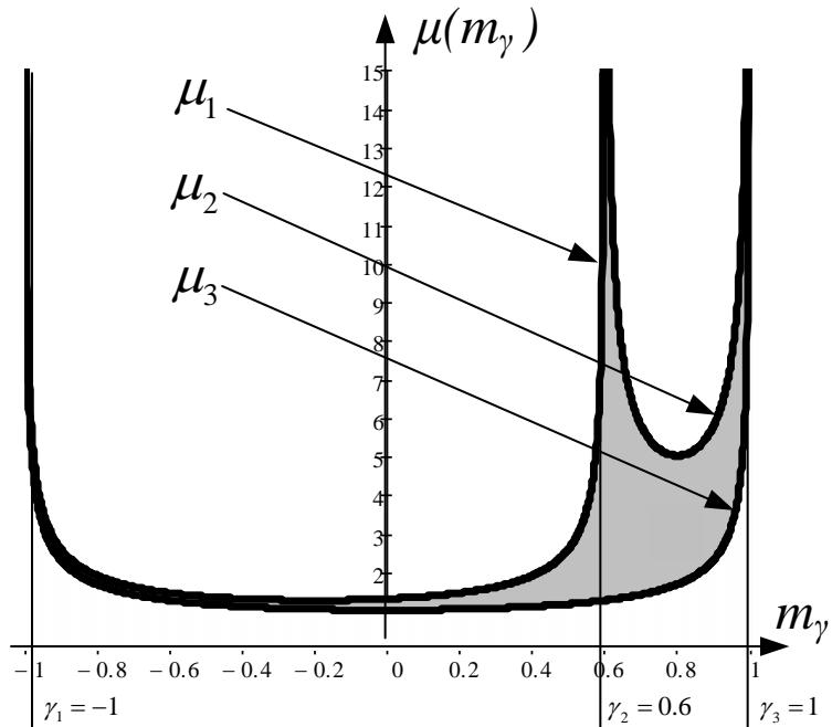
Рисунок 2 – Границы диапазона (сплошная черная линия) и диапазон (закрашен серым цветом), в котором возможно независимое управление параметрами ПРВ ШК для неэквидистантной трехточечной модели
