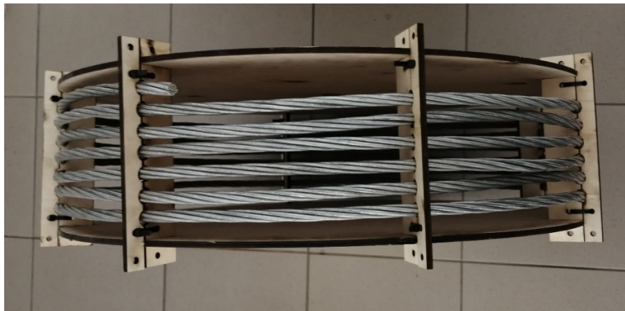
Рисунок 10 – Образец без ферромагнитной ленты для сравнения (макет силового реактора)
