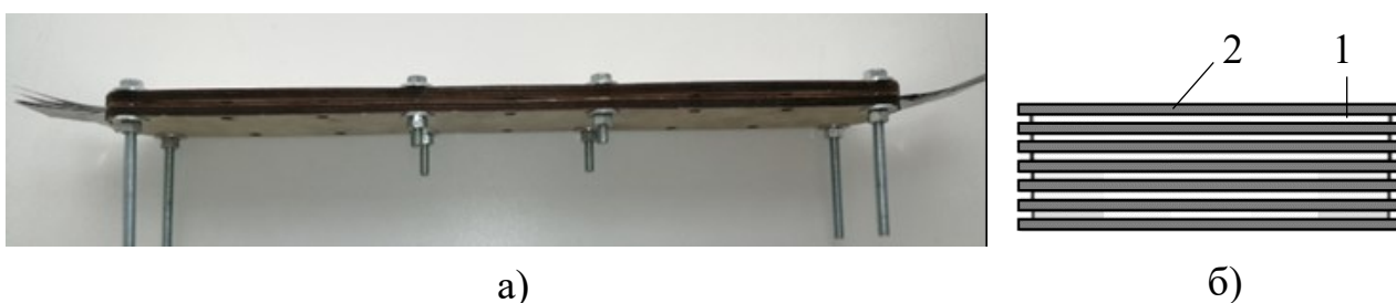
Рисунок 6 – Макет плоского многослойного проводника: а) фотография образца, б) эскиз конструкции проводника в поперечном сечении (1 – алюминиевый проводник, 2 – ферромагнитный слой)
