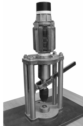
Рисунок 34 – Модернизированная двухкатушечная СЭМУД
