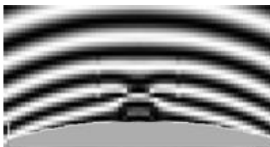
Рисунок 7 — Момент ионизации пузырька на расчетной керрограмме
