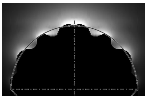
Рисунок 20 — Распределение напряжённости поля по поверхности модифицированной модели стримера. Белый — максимальное значение E
