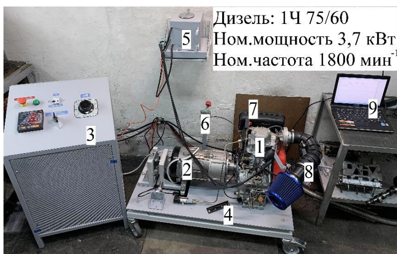
Рисунок 3 – Фотография установки для стендовых испытаний ПДВС: 1 – одноцилиндровый дизель; 2 – электрическое нагружающее устройство (генератор); 3 – блок управления установкой (пуск / останов / нагрузка / приборы и т.д.); 4 – основание (виброгасящая плита); 5 – топливный бак; 6 – рукоятка управления подачей топлива; 7 – система выхлопа; 8 – система впуска; 9 – ПК для сбора и обработки данных испытаний
