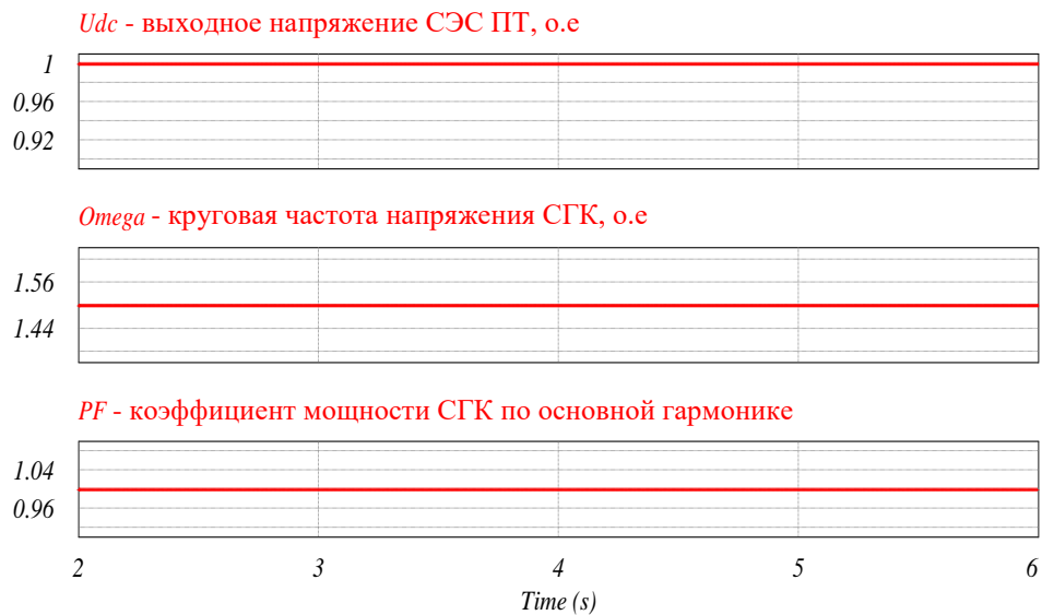
Рисунок 21 – Астатическое регулирование выходного напряжения постоянного тока СЭС ПТ, Вариант № 1, U_{dc} = 1.0 , \psi_0 = 0.681 , \omega_0 = 1.5 , PF = 1.0 , единицы измерения относительные
