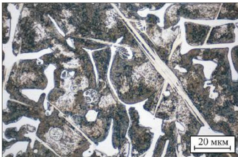
Рис.6. Дендритные построения в покрытии, полученном спеканием твердосплавной смеси марки ВК6 на хромированной стали 20.
